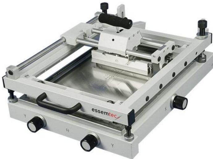
Obr. 6 Zařízení pro šablonový tisk [14]
