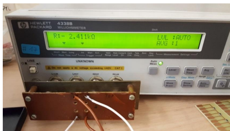
Obr. 26 Miliohmometr HP – měření odporu
