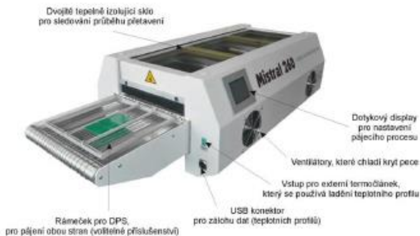
Obr. 22 Pec Mistral 260 pro pájení přetavením [11]
